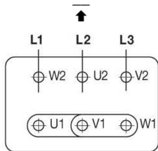
Collegamento bassa velocità - *Connection low speed* - Connexion petite vitesse - Schaltung Niedrige Drehzahl - Conexión baja velocidad
